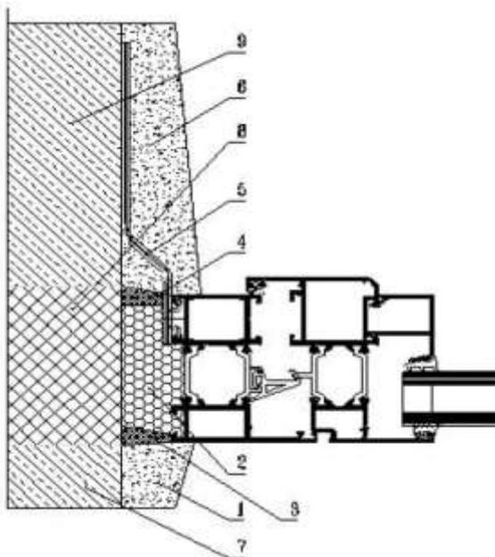
Рисунок А.2 - Узел примыкания оконного блока к стеновому проему без четверти слоистой кирпичной стены
