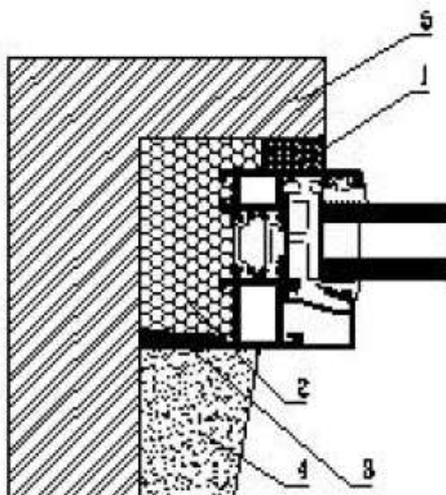
Рисунок А.3 - Узел примыкания оконного блока к стеновому проему с четвертью в однослойной стене (кирпичная кладка).
