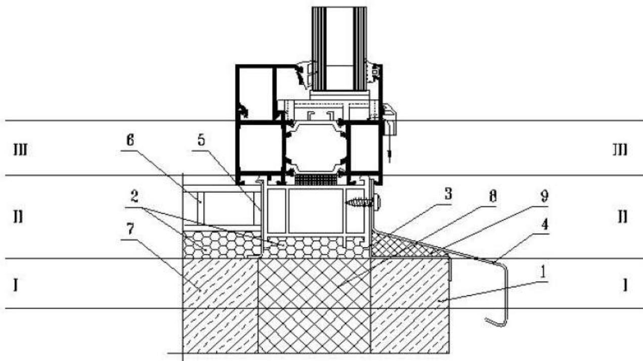
Рисунок 4.1- Узел примыкания алюминиевой конструкции к проему многослойной стены (возможный вариант).
