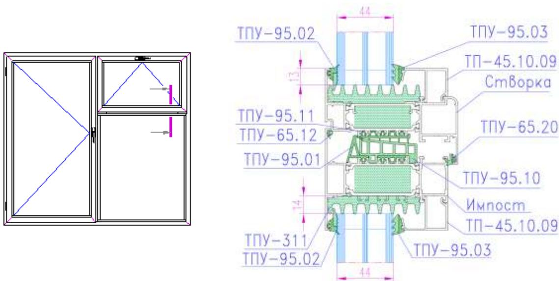
Окончательно зафиксировать стеклопакет штапиком по периметру. Сначала установить горизонтальные штапики, затем вертикальные и заложить резиновое уплотнение ТПУ-95.03.
