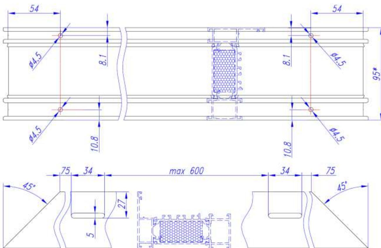
Пробиваются дренажные отверстия  $34 \times 5$  мм для отвода влаги...
