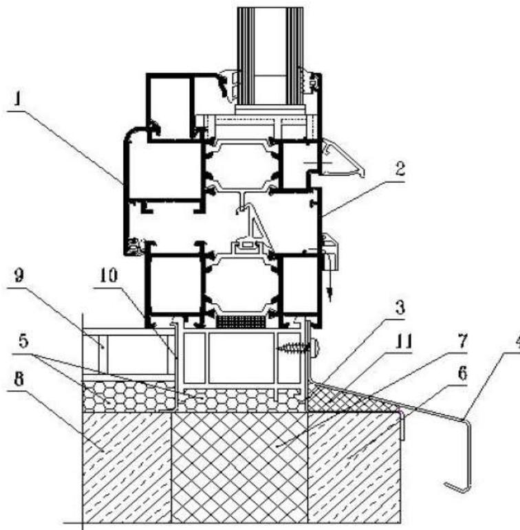
Рисунок А.1 - Узел примыкания алюминиевого оконного блока к проему слоистой кирпичной стене с отделкой наружных и внутренних откосов штукатурным раствором.
