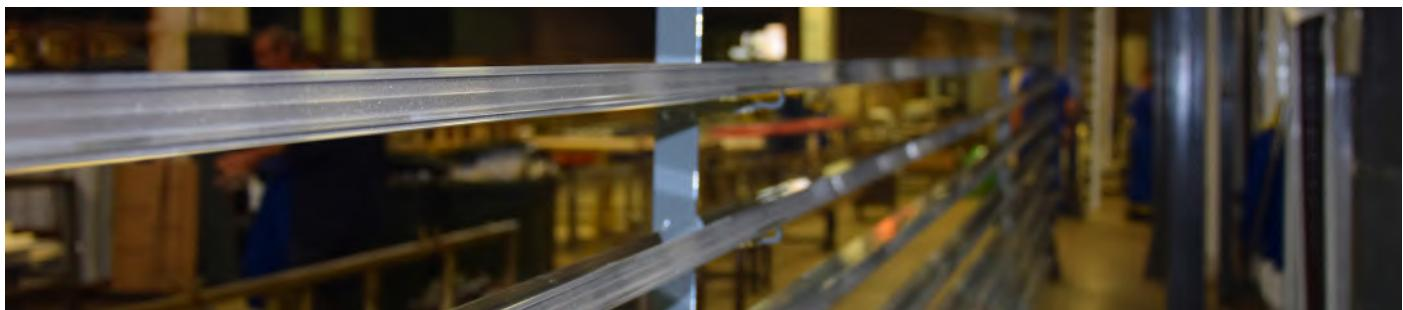
Из нее пуллер вытягивает уже готовый профиль. Компьютер определяет необходимую длину профиля, отрезает и направляет на термическую обработку (закалку и старение). Потом он красится, упаковывается.
